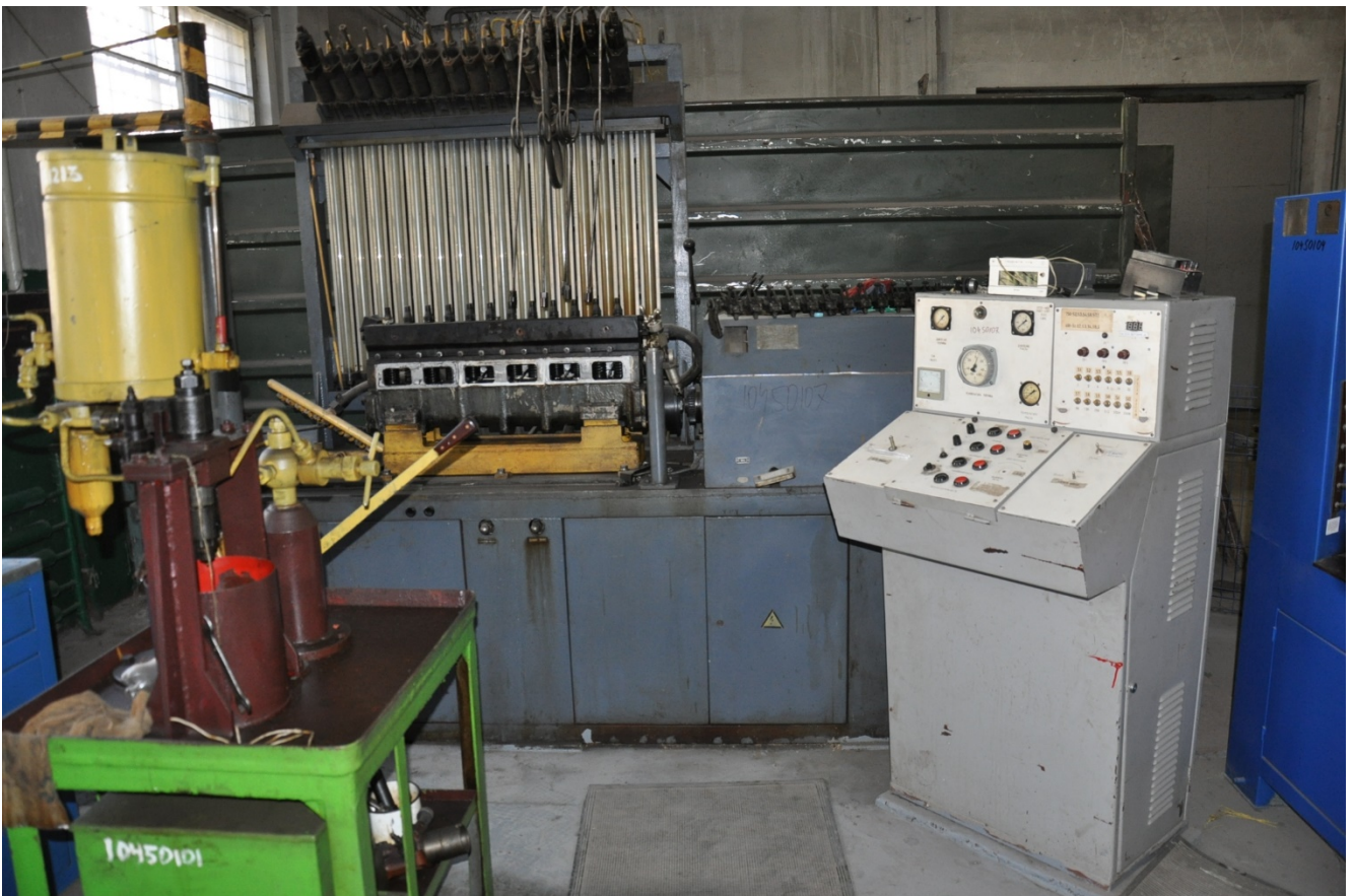
Стенд для випробування дизель-генераторної силової установки
